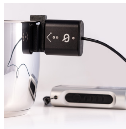
Adapter aus dem 3D-Drucker
