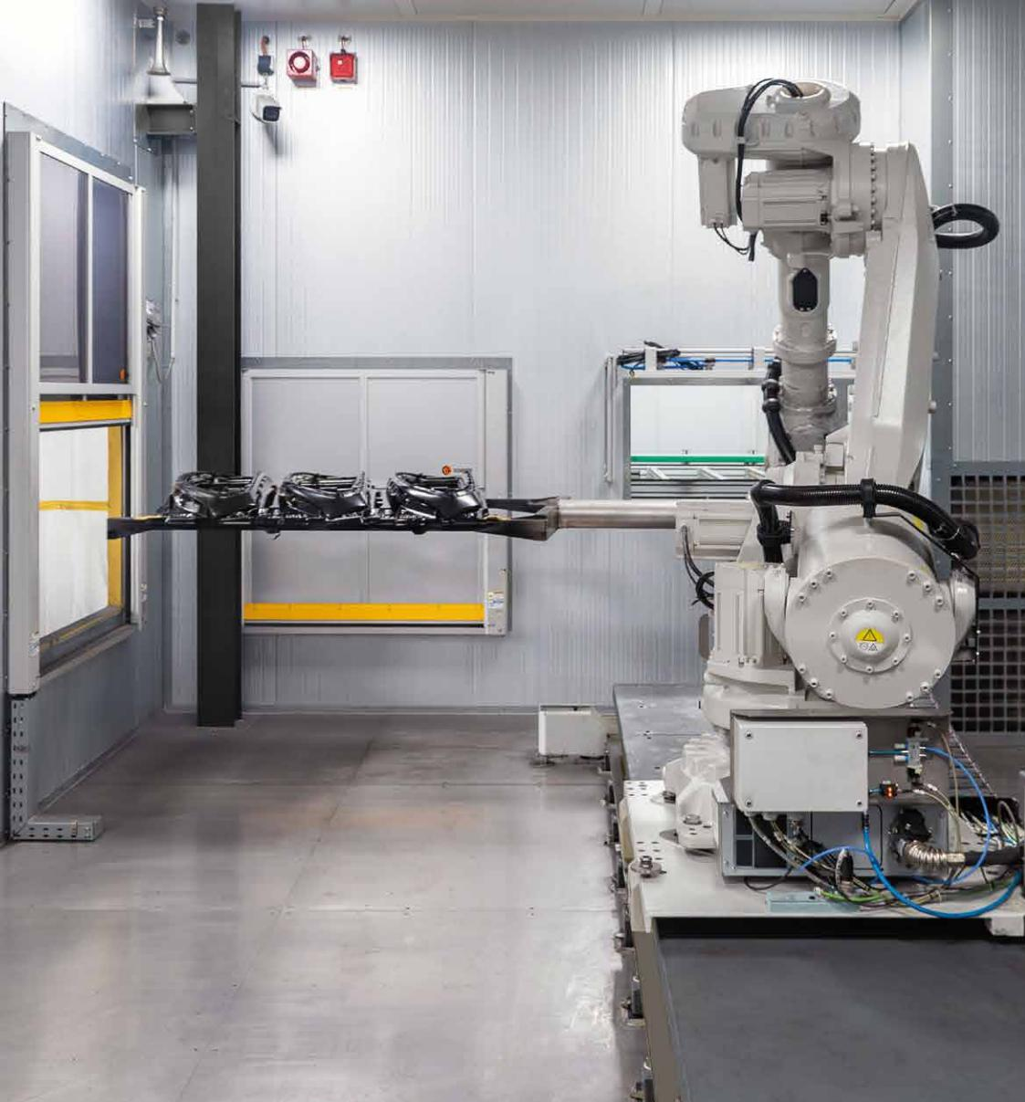
Oft ist in gewachsenen Gebäudestrukturen wenig Platz für die Integration einer komplexen Beschichtungsanlage. Hier setzt unser Konzept der Smart-Compact-Painting-Line an. Im Gegensatz zu konventionellen Durchlaufanlagen ermöglicht die RIPPERT Smart-Compact-Painting Line einen individuellen Anlagenbau. In dieses modulare Konzept können verschiedene Vorbehandlungsoptionen wie z.B. CO2-Reinigung, Plasma, Beflammung und auch Ionisation integriert werden.
