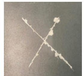
Alu 6000 | 1-Schicht Pulverbeschichtung | 1008 Std ESST
