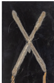
Stahl | 1-Schicht Pulverbeschichtung | 480 Std NSS
