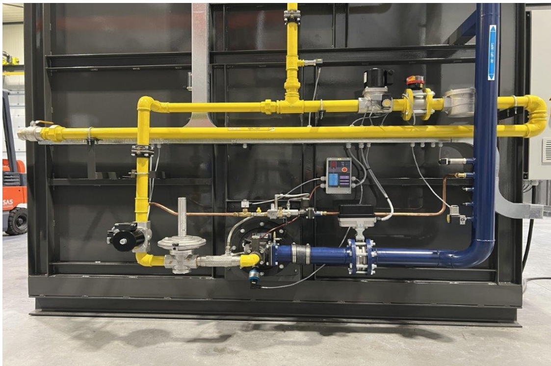
Foto : Industrieller Ofenbrenner mit integrierter Pilotbrenner
