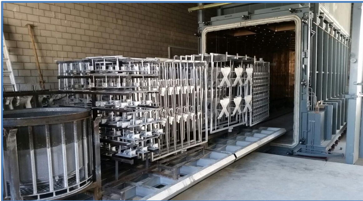
Foto : Beladung Einfuhrwagen bevor Anfang der Pyrolyseprozess
