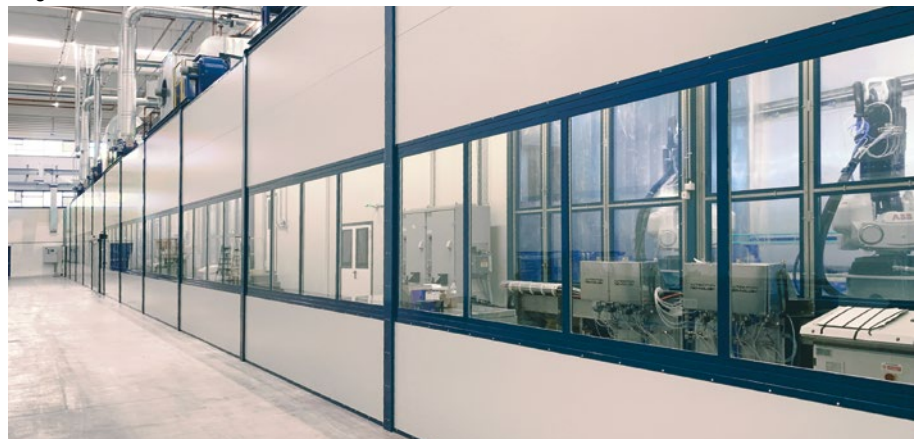
➤ Step by step Nasslackieranlage mit Bodenförderer für die Automobilindustrie
