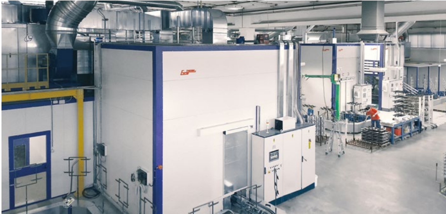
➤ Automatische Step by step Nasslackieranlage mit Bodenförderer
