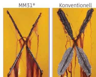
Stahl | 1 Schicht Pulverbeschichtung | 1008 Std NSST
