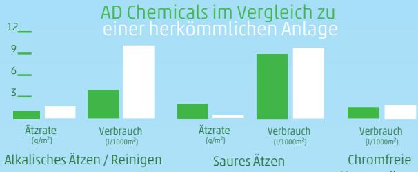
Bei herkömmlichen Anlagen verursacht die Reinigungs- und Ätzzone mehrere negative Nebeneffekte, u.a. eine stärkere Verunreinigung in den nachfolgenden Prozessschritten und die Bildung von Schlamm, was zu unnötigen Abwassermengen führt. Das Verfahren von AD Chemicals verfügt über optimierte Ätzschritte, die den (Abfall- und) Wasserfluss verbessern.
