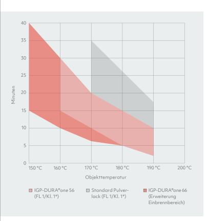
Hochreaktive Pulverlacke ermöglichen eine unmittelbare Temperatursenkung und gewährleisten dabei eine sichere Vernetzung des Lackfilms.
