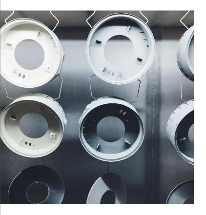
Ein weites Einbrennfenster bietet hohe Farb- und Glanzstabilität bei unterschiedlichen Beschichtungsparametern und -materialien.
