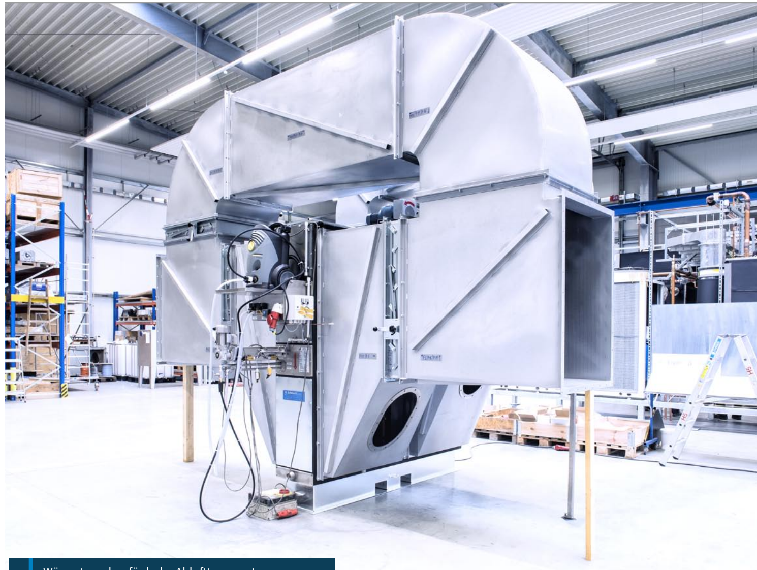
Wärmetauscher für hohe Ablufttemperaturen
