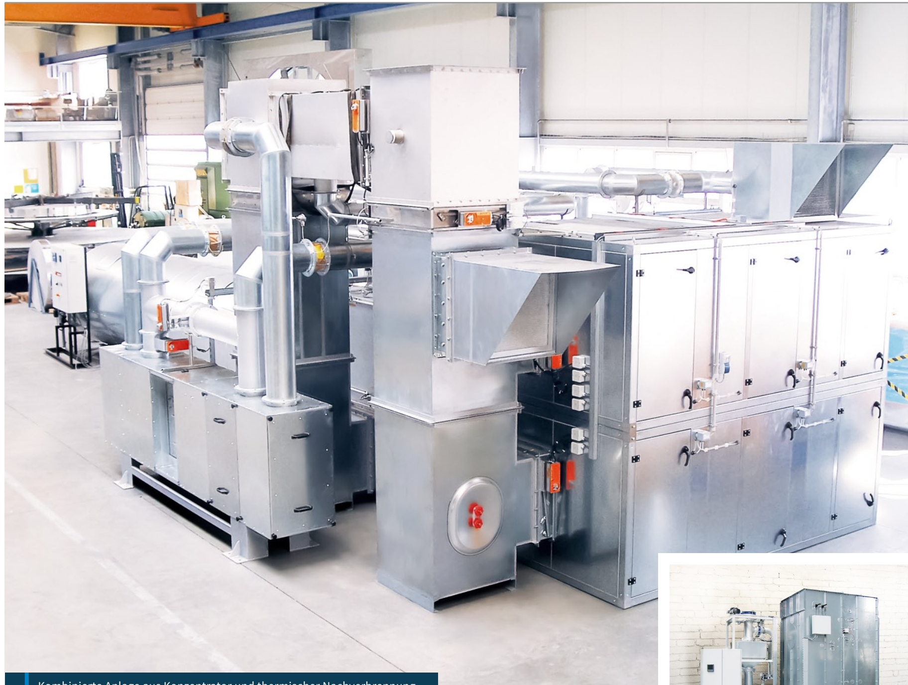
Kombinierte Anlage aus Konzentrator und thermischer Nachverbrennung
