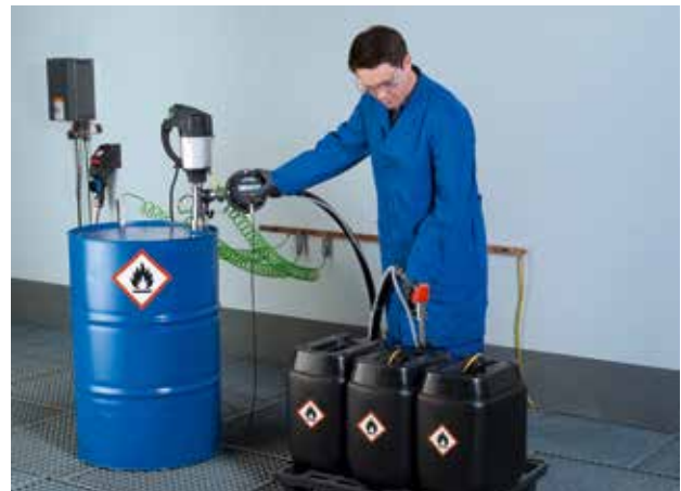
Halbautomatische Kanisterbefüllung in Ex-Zone 1.
