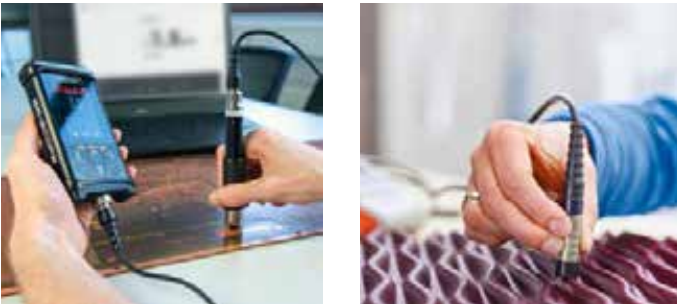
Links: Messung der Kupferdicke auf Leiterplatte Rechts: Messung von Isolierbeschichtung
