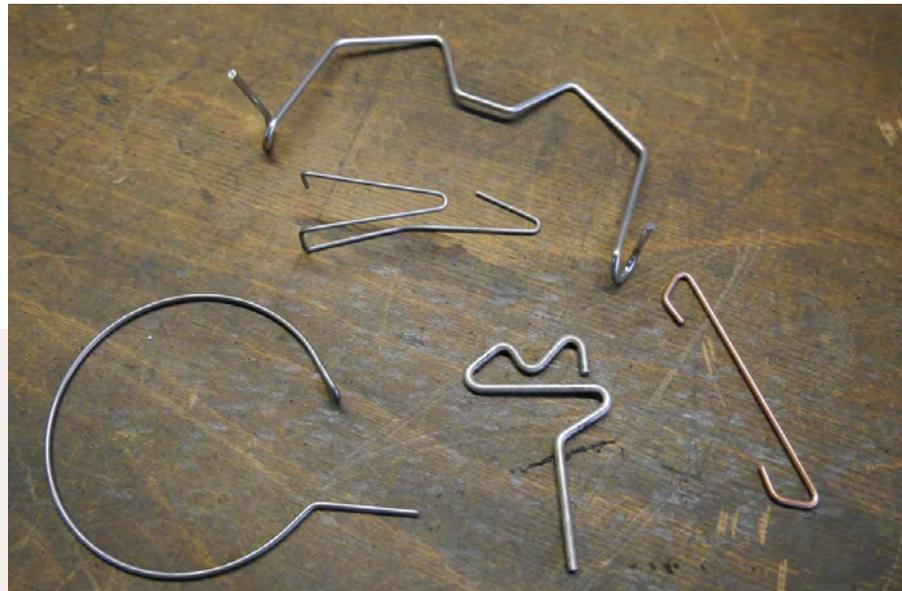
Zwei- und dreidimensionale Drahtbiegeteile mit Durchmessern zwischen 1,5 und 3 mm.
