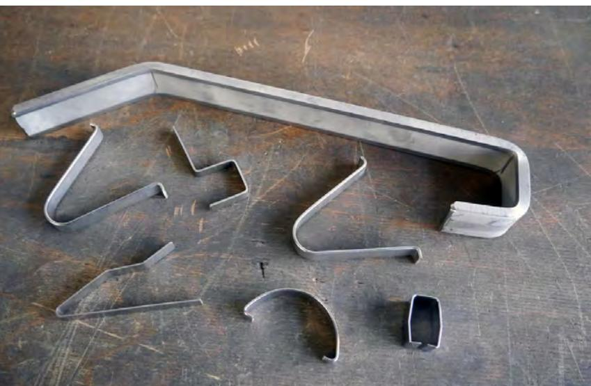
Federklammern aus VA-Federstahl und Aufhängehaken aus Flachmaterial (30 x 8 mm).
