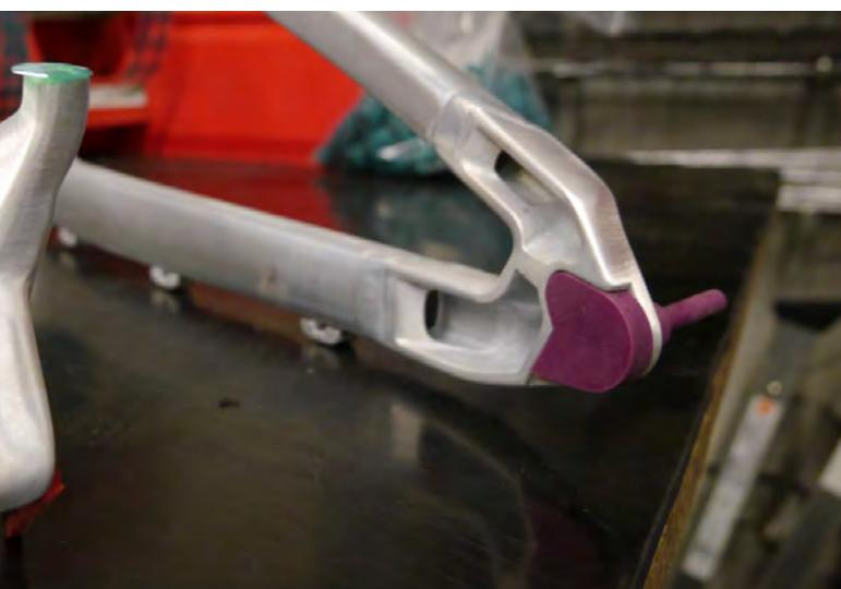
Durchziehstopfen zum konturgenauen Maskieren der Fläche und zum Schützen der Bohrung.
