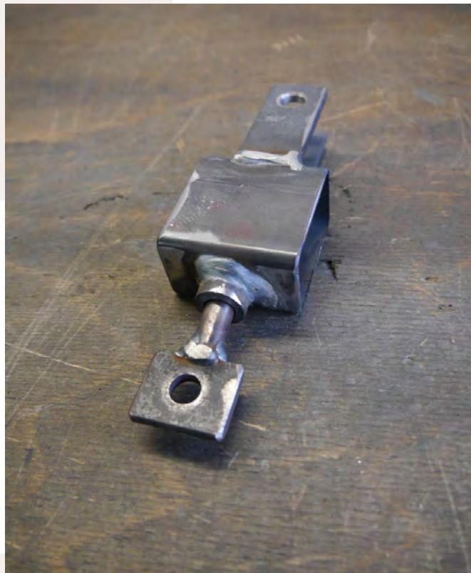
Offene Drehvorrichtung mit einer Arretierung von je 90°.
