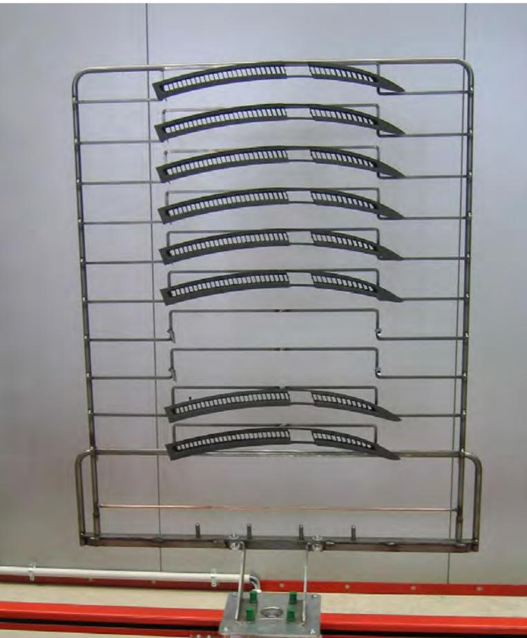
Lackiergestell für einen Bodenförderer. Das Kunststoffgitter wird über Drahtbügel und zwei Klemmfedern gehalten.
