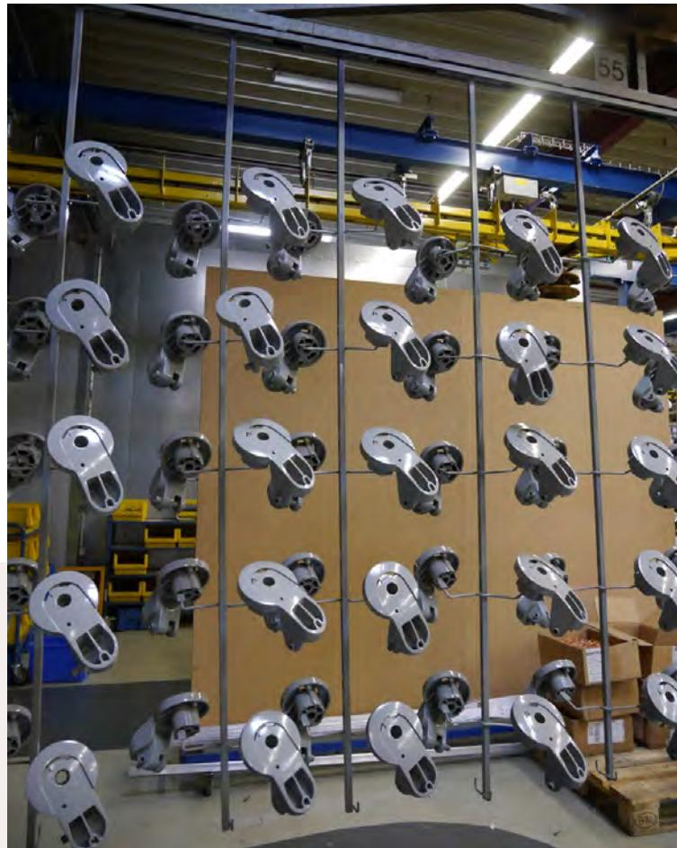
Vertikales Gehänge mit fest verschweißten Aufnahmearmen. Die Bauteile sind beidseitig versetzt angeordnet.
