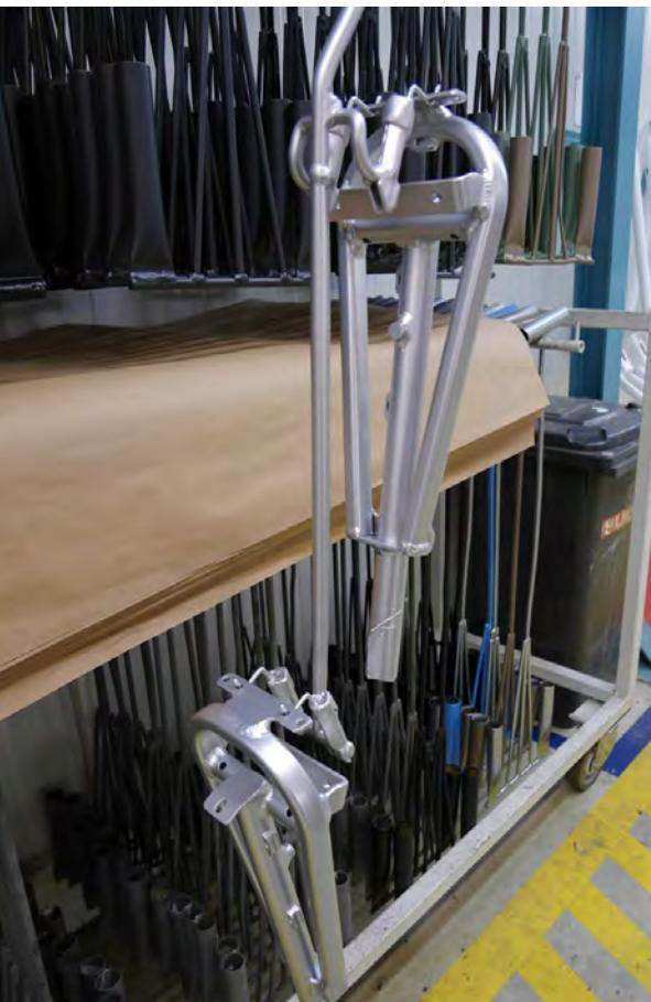
Kundenspezifisches Lackiergehänge mit angeschweißten Standardkomponenten (Vierkant-röhrchen des Flexgehänges).
