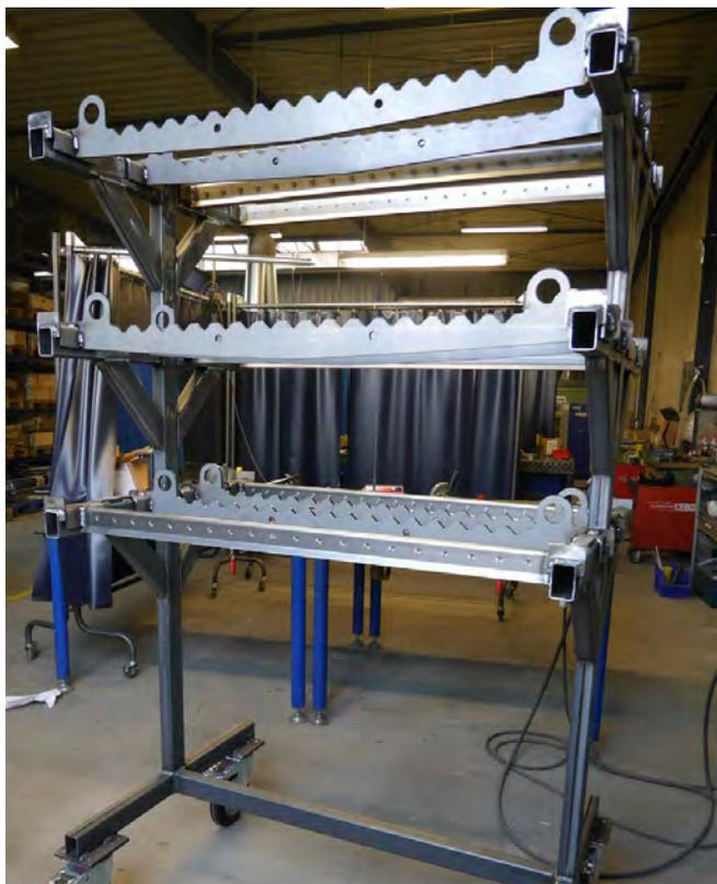
Traverse passend für Lackierwagen, aus Flachmaterial als Zackenleiste gefertigt.
