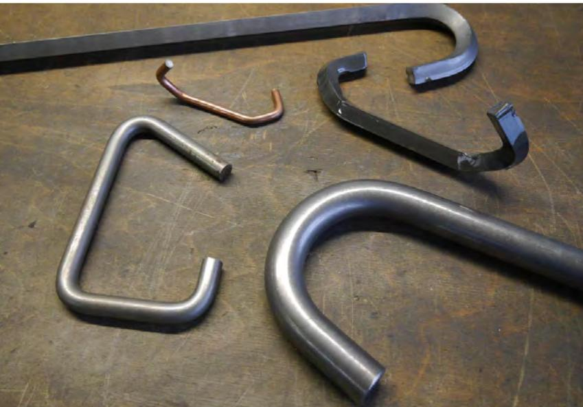
Biegeteile aus Vierkant- und Rundmaterial mit Durchmessern zwischen 8 und 30 mm.
