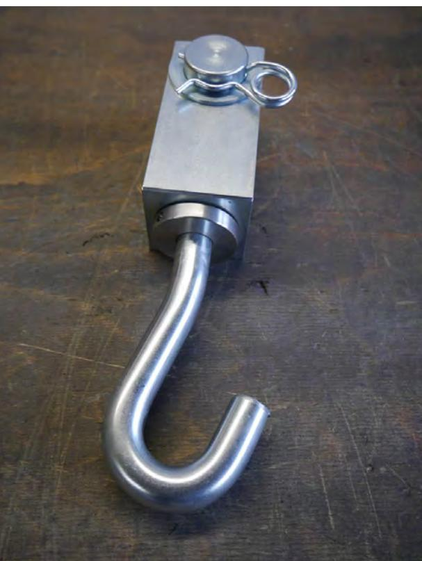
An die Lackieranlage angepasste Drehvorrichtung (belastbar bis max. 750 kg).
